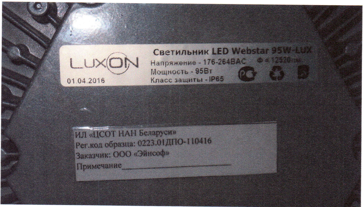
Рисунок 7 – Фотография маркировки образца светильник светодиодный WebStar 95W (LUX) и его регистрационной этикетки
