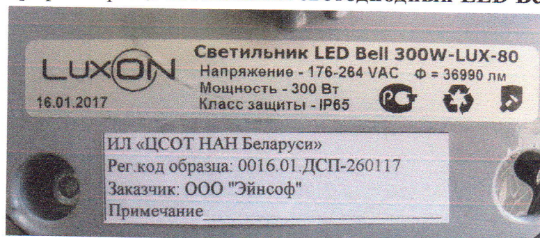
Рисунок 5 - Фотографии образца светильник светодиодный LED Bell 300W-LUX-80
